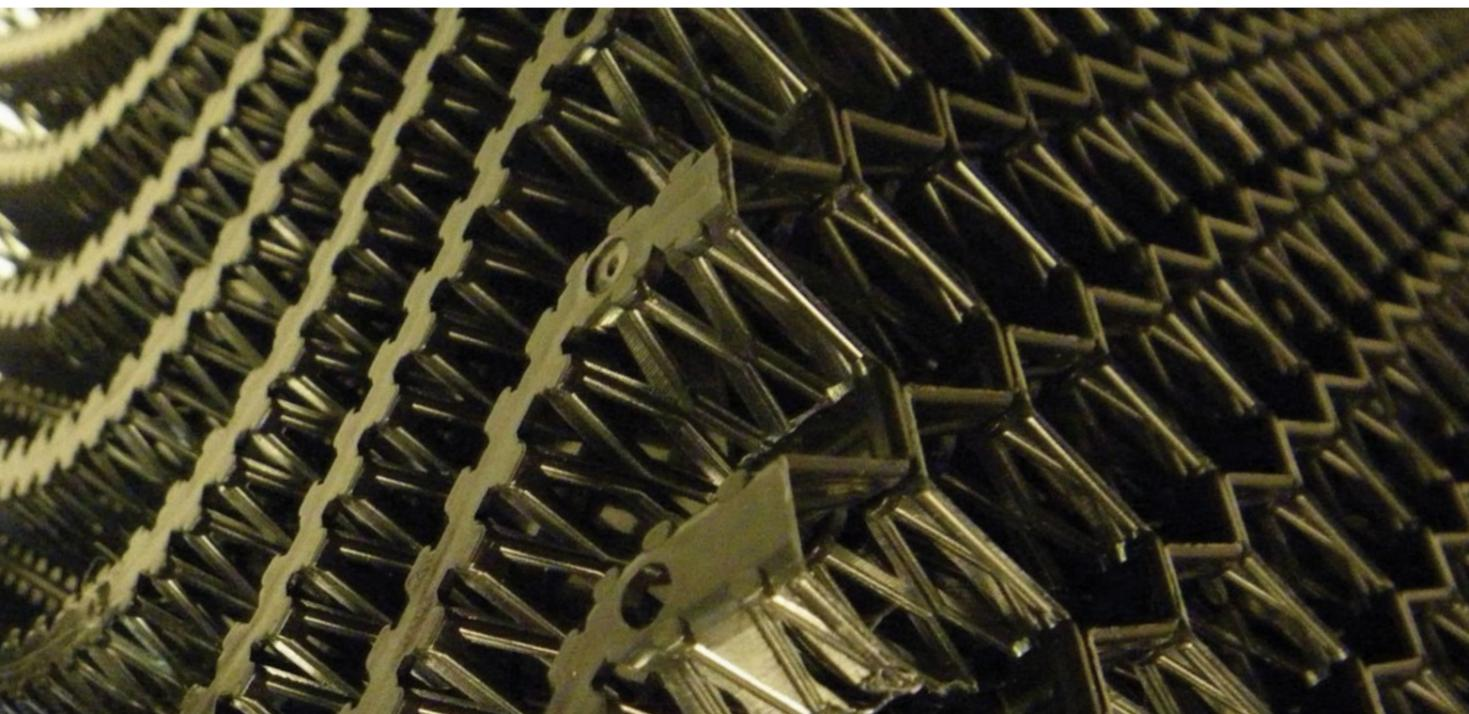
**E** Paneles de Polipropileno estabilizado con altas prestaciones mecánicas. Eficiencia en superficie de aprox. 260m<sup>2</sup>/m<sup>3</sup>. y un peso de 11 Kg/m<sup>2</sup> (panel 150mm). Estos paneles pueden trabajar perfectamente entre los -20° y los + 80° de temperatura. Al estar fabricados con PP ofrecen una perfecta resistencia a hongos y bacterias.
