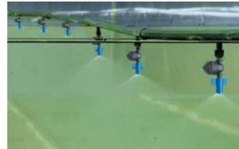
**E** En combinación con la ventilación estática o dinámica, el sistema de NEBULIZACIÓN es la forma más económica de eliminar el impacto negativo de las altas temperaturas sobre la producción. La nebulización efectiva ha de refrescar sin mojar. Por eso nuestras BOQUILLAS están diseñadas para conseguir gotas tan pequeñas que garantizan su suspensión y el perfecto intercambio de frío con el ambiente. Sin goteos ni concentraciones de humedad
